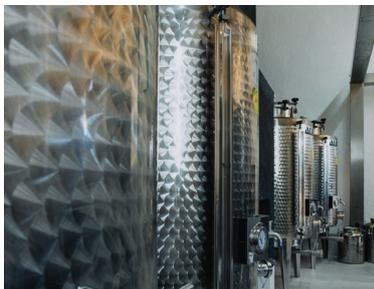
Spezialtanks aus Edelstahl mit polierten Schweißnähten im Innern, die zur Lagerung des Öls dienen. Hermetisch verriegelt und mit einem Schutzgas befüllt, wird Oxidation und Fermentation verhindert, so dass die Qualität unvermindert erhalten bleibt.
