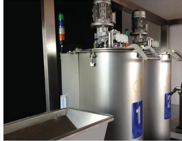
Nach dem Entkernen werden die Oliven - ohne Wasserzugabe - in einen geschlossenen Malaxierer mit Vakuum gegeben. Bei diesem Arbeitsschritt wird die Olivenmaische für die Extraktion des Öls vorbereitet. Enzyme öffnen die Fruchtzellen, so dass nach und nach kleine Öl-Tröpfchen aus den Zellen treten.
