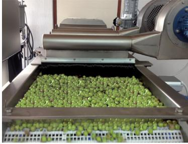
Nach der Ernte landen die Oliven in der Waschstraße: Eine für OLI DE SANTANYI entwickelte mobile Wasch- und Trockenanlage reinigt die Oliven und entfernt überschüssiges Wasser mit einem Spezialgebläse, so dass höchste Hygienestandards eingehalten werden können.
