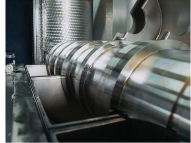
Im Zwei-Phasen-Dekanter erfolgt die Extraktion des Olivenöls - ähnlich wie bei einer Zentrifuge. Dabei werden Feststoffe, Wasser und Öl voneinander getrennt. Die tägliche Reinigung des Dekanters und aller weiteren Komponenten der Mühle gilt bei OLI DE SANTANYI als Selbstverständlichkeit.
